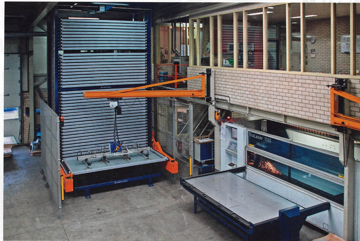
De gewenste plaat wordt met een vacuümheffer rechtstreeks uit de toren gepakt en op het bed van de lasersnijmachine gelegd.
